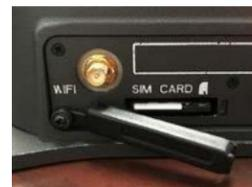
Pasang kartu SIM dari penyedia waktu siar seperti berikut. Masukkan kartu dengan kontak bawah seperti yang ditunjukkan hingga terdengar bunyi mengunci. Pastikan untuk mengunci kartu SIM dan pasang penutup SIM setelah kartu SIM terkunci dengan aman
