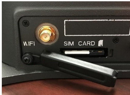
GAMBAR 3-3 KARTU SIM DENGAN PENUTUP TERBUKA
