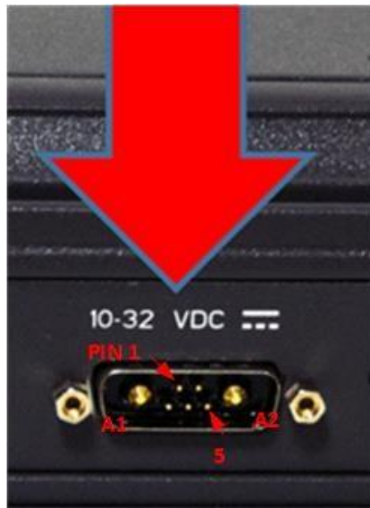
Gambar 7-4 Detail 10-32 VDC dan Konektor Mating
