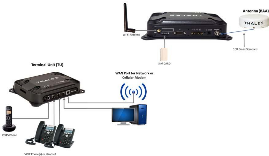
Gambar 1-1 Sistem MissionLINK™ dengan Hardware Terhubung
