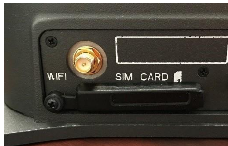
Gambar 2-9 Kunci Penutup Kartu SIM dengan Aman
